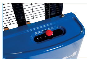
Betjeningspanel med nødstop
