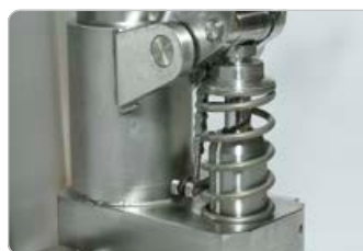
Pumpehus i 100% rustfrit stål
